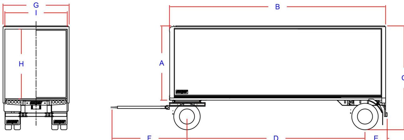
**E**n su diseño se ha priorizado disminuir la tara y aumentar el volumen interior. De esta forma se baja el consumo de combustible de la unidad remolcadora y el desgaste de los neumáticos. En consecuencia, rentabilizamos la operación al poder trasladar mayor volumen o peso según sea el caso.
